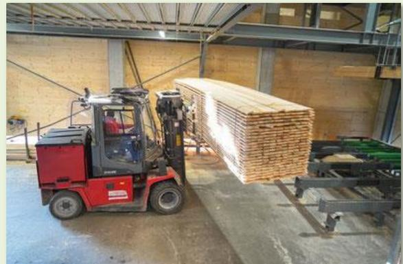
*Gabelstapler transportieren die Bündel in Zwischenlager*
