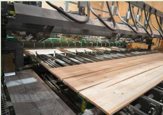
*Bretter werden zu Bündeln gestapelt und zu Verkaufseinheiten "konfektioniert"*
